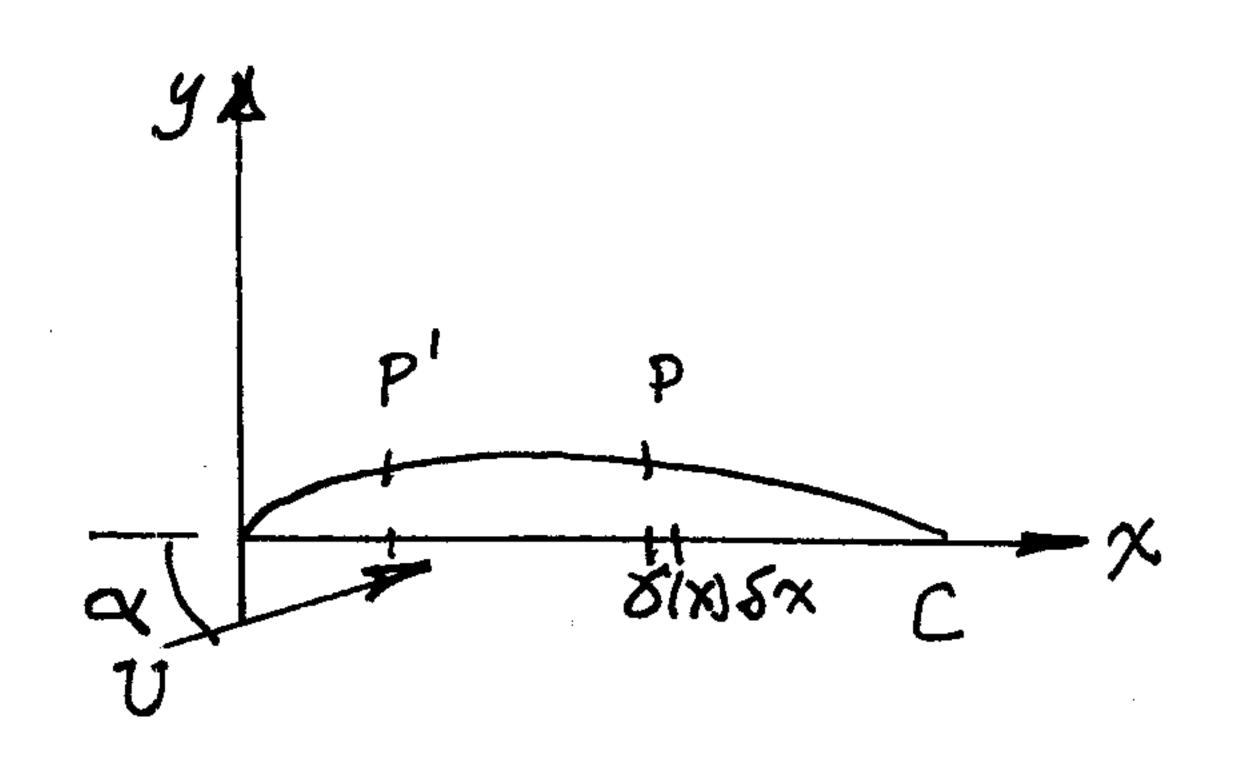
NOW &(x) IS DISTRIBUTED ALONG THE CHORD LINE AND NOT THE MEAN CAMBER LINE.
