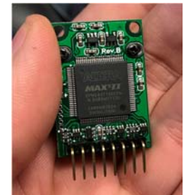
Altera CPLD (like FPGA)
