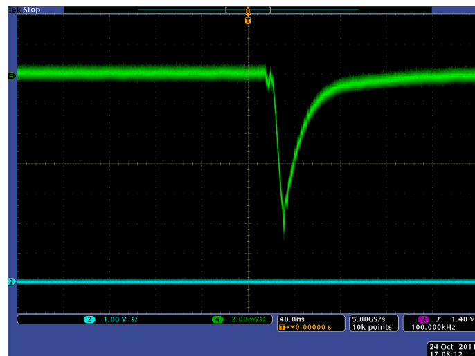
Abbildung 34: Ergebnis der roten LED des Herstellers HLMP (Typ EG15-UX00) im Schaltsystem des LED-Driver-Boards. (Zeitachse: 40ns/div. Intensität: 2mV/div.). Auch in dieser Betriebsart der LED bleibt das Signal kurz genug.
