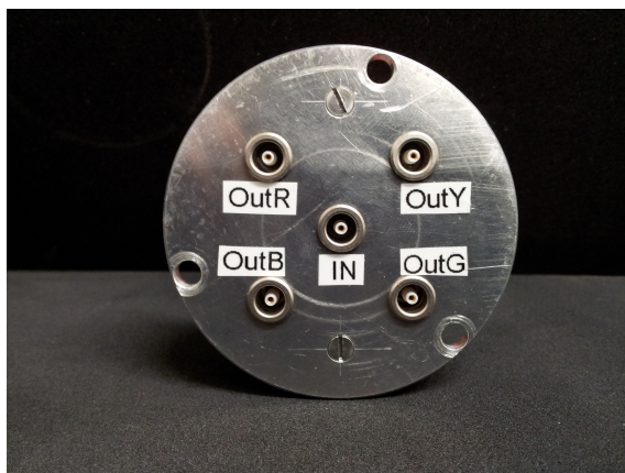
Abbildung 13: Eingänge des LED-Driver-Boards. Die Kürzel bei den äußeren Eingängen entsprechen den Farben der zunächst eingesetzten LED's (gelb, grün, rot, blau).
