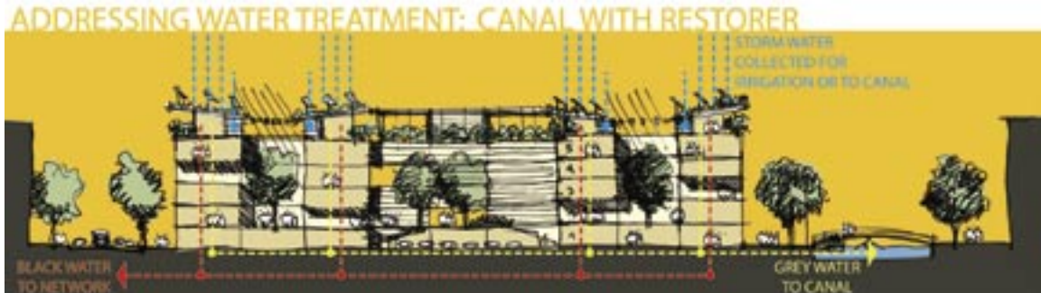
水处理：有污水修复器的水道
